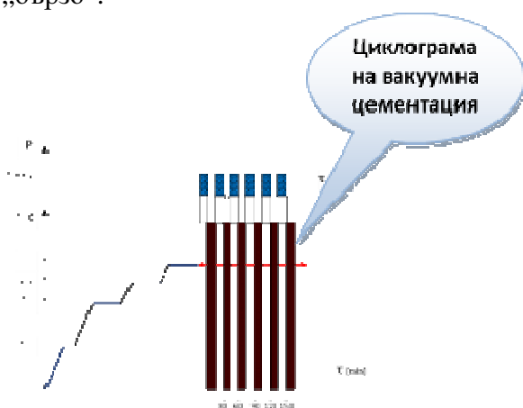
Фиг.2. Циклограма на вакуумна цементация
