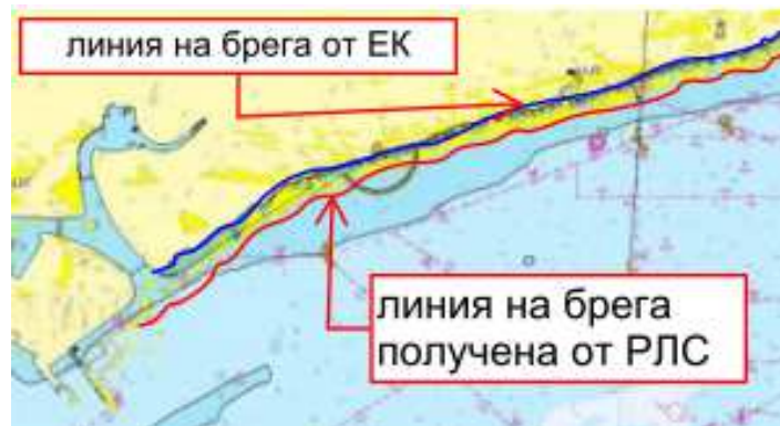
Фиг. 3 – Несъответствие в бреговата линия получена от радарното изображение и тази на електронната карта, картографска грешка
