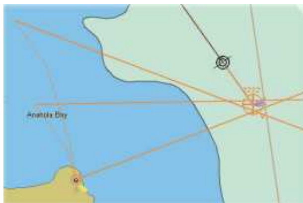
Фиг. 5 – Използване на линии на положението за ръчно ОМК върху електронна карта
