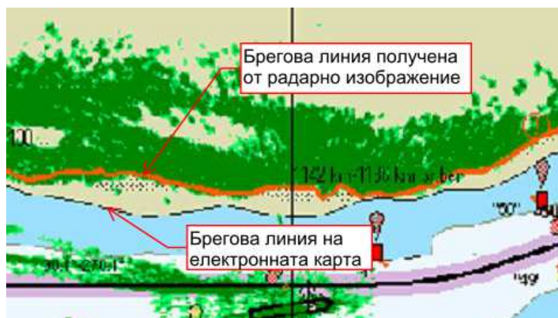
Фиг. 2 – Несъответствие в бреговата линия получена от радарното изображение и тази на електронната карта
