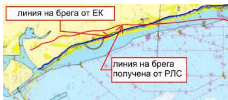
Фиг. 4 – Завъртане на радарното изображение в следствие на грешно подадена информация от сензора на ЖК
