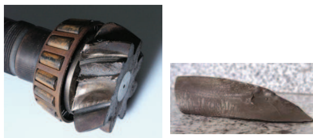
Фиг.3. Счупване на зъб на зъбно колело вследствие умора
