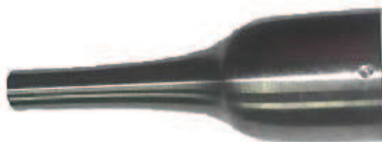
Фиг. 6. Сонотрод след повърхностно плазмено азотиране
