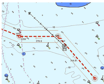
Фиг. 6 – Пример за изобразяване на мястото на кораба върху електронна карта
