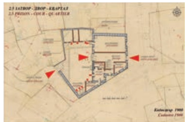
Фиг. 8. План на първото ниво на затвора по данни от 1921 (Фиг. 7) и кадастър от 1900 Чертеж: Н. Стаматова, 2024
