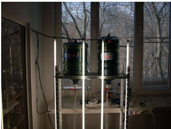
Фиг.2. Примерен тип инсталация , разработен в лабораторията по фитопланктон в ИРП-Варна с обем 20 л за поддържане на постоянна лабораторна култура.
