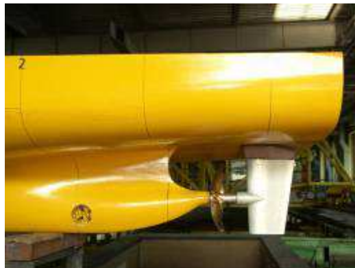
Фиг.7 Корабен модел с интегрирана винтово-рулева система (PROMAS)
