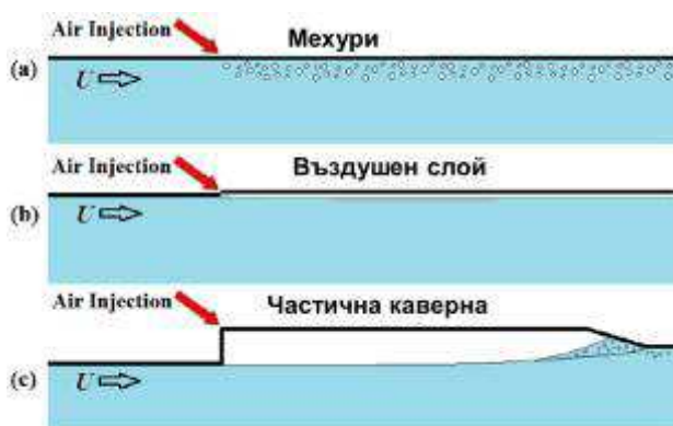
Фиг.10 Типове въздушна смазка a - мехури, b - въздушен слой, c - частична каверна
