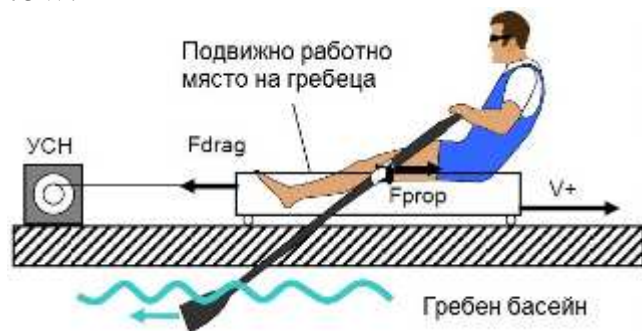
Фиг.1. Задвижване на малки плавателни средства с мускулна сила
