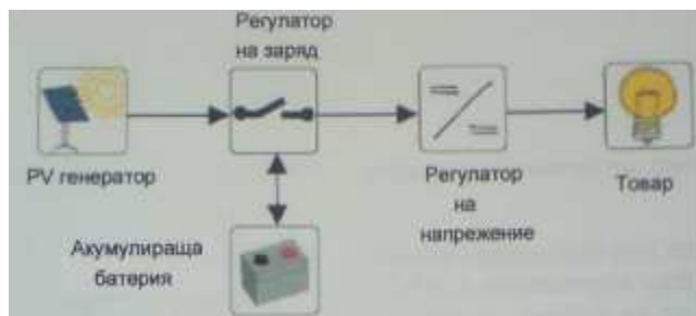
Фиг.3. Схема на фотоволтаична система
