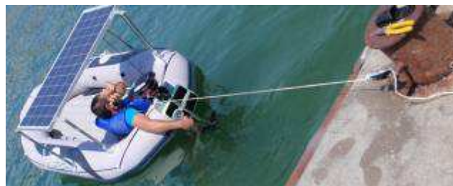
Фиг.10 Определяне на упора в швартовни режим
