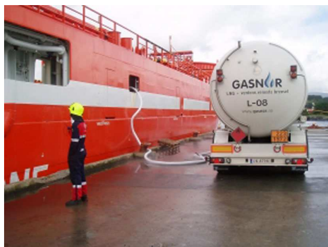
Фиг.12.Бункерване от камион на брега [13]
