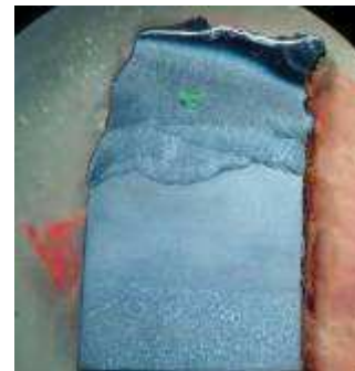
Фиг.2 Макрошлиф на образец след плазмено рязане (рубене)
