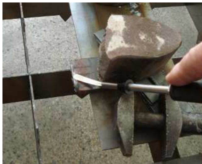
Фиг.12 Термодвойка за отчитане на резултатите от повърхностното рязане
