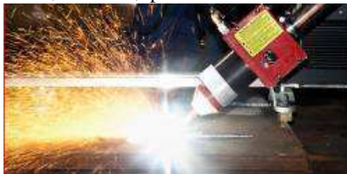
Фиг.1 Въздушно - плазмено – повърхностно рязане
