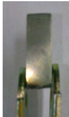
Фиг. 1. Образец от Ti 64 подготвен за азотиране
