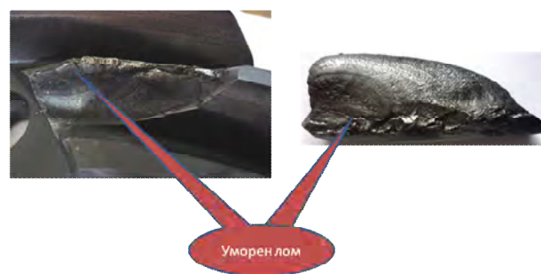
Фиг. 7. Лом от откъртена част на короната
