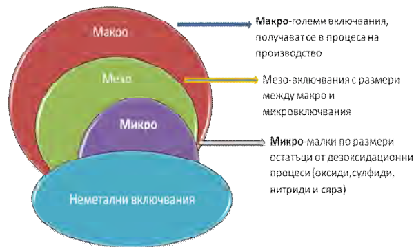
Фиг. 3. Видове неметални включвания в зависимост от тяхната едрина.
